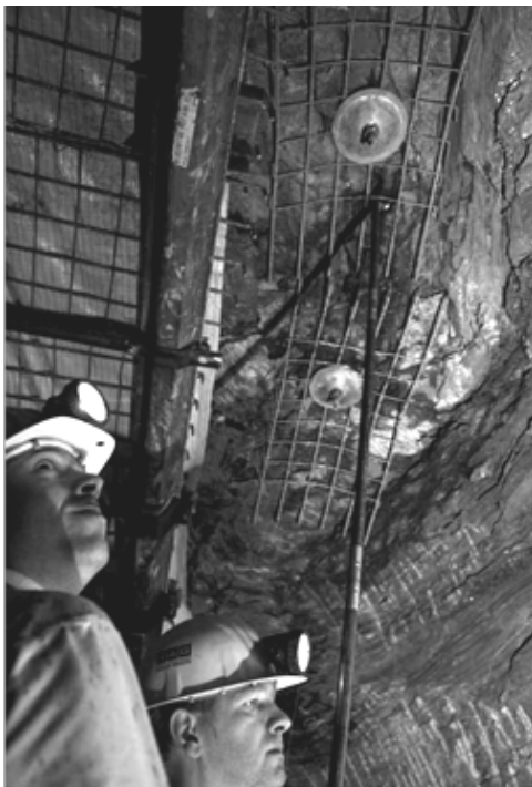
Рис. 3. Установка скважинного видеозонда в скважину для съемки ее поверхности обнажения
