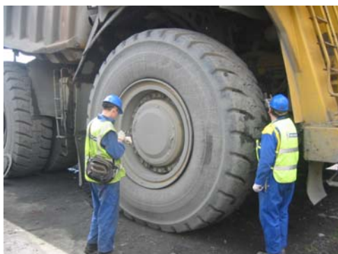
Рис. 3. Техническая инспекция КГШ представителями фирмы-производителя: а – рабочих шин; б – демонтированных шин
