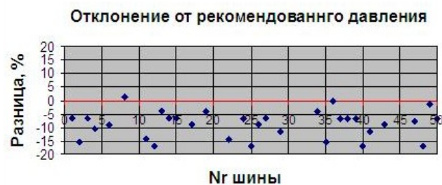
Рис. 5. Примеры анализа отклонения от рекомендованного давления накачки: а – преимущественная перекачка; б – преимущественная недокачка
