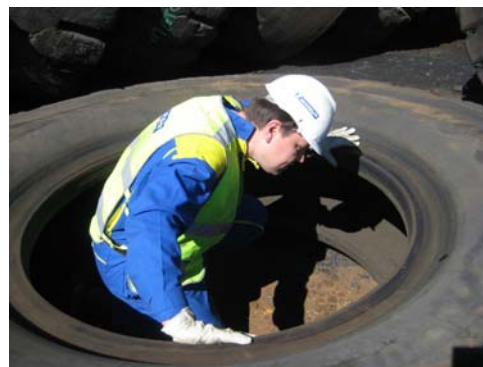
Рис. 3. Техническая инспекция КГШ представителями фирмы-производителя: а – рабочих шин; б – демонтированных шин
