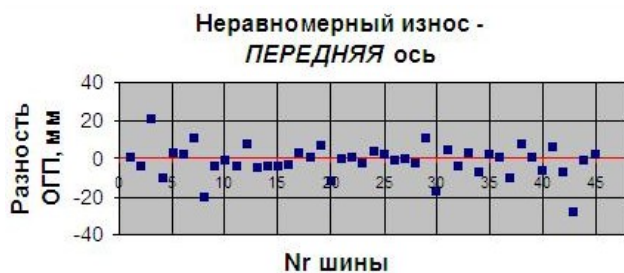
Рис. 7 Пример анализа неравномерного износа КГШ:
