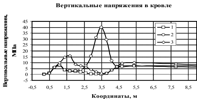
Рис. 5. Вертикальные напряжения: 1 – при исходном положении забоя; 2 – при выемке стружки по длине забоя; 3 – при разгрузке, передвижке и распоре механизированной крепи
