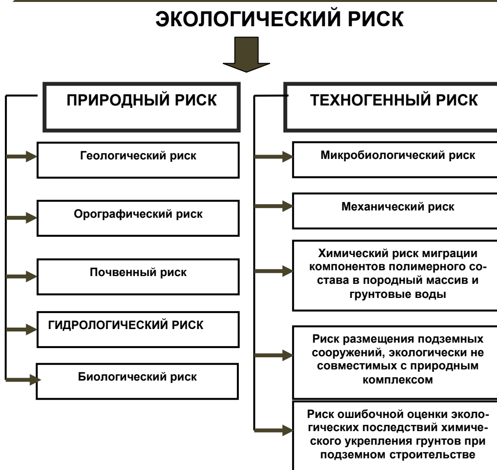
Рис. 4. Экологический риск при строительстве городских подземных сооружений с применением химического укрепления грунтов
