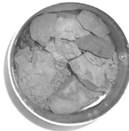
Рис. 2. Образцы после 7 циклов замораживания-оттаивания
