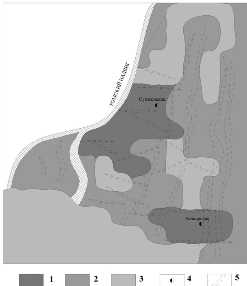
Схема районирования шахтных полей по степени геодинамического риска: 1, 2, 3 – соответственно зоны высокого, среднего и низкого риска возникновения геодинамических явлений при затоплении шахты; 4 – стволы шахт; 5 – тектонические нарушения
