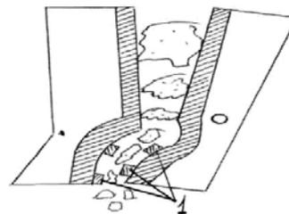
**Рис. 3. Схема щековой дробилки для получения щебня кубической формы:** 1 – дробящие ребра
