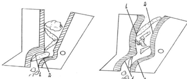
**Рис. 2. Принципиальные схемы щековых дробилок для дробления «плоскушки»:** 1 – углубление на неподвижной щеке, 2 – выступ на подвижной щеке
