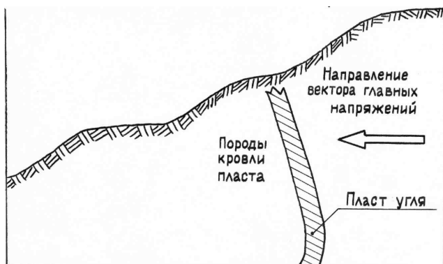
Рис. 3. Схема деформации угольного пласта под действием горизонтальных перемещений
