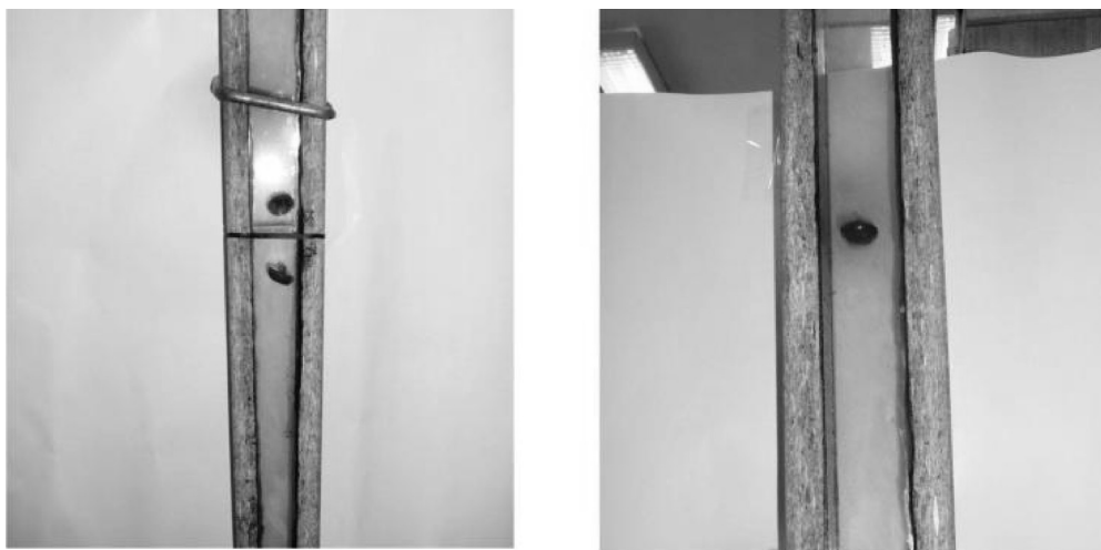
Рис. 1. Парение пластиковых дисков в условиях установившейся скорости восходящего потока воздуха
