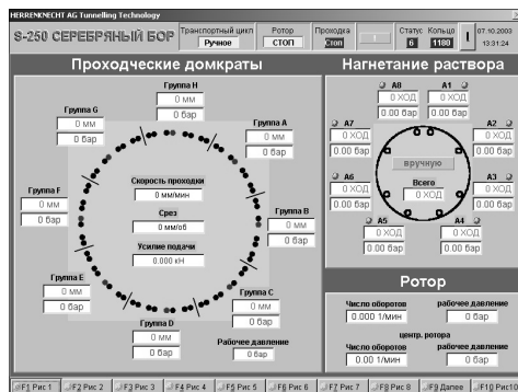
1 экран визуализации ТГМК 14,2 м: проходческие домкраты, нагнетание раствора, ротор
