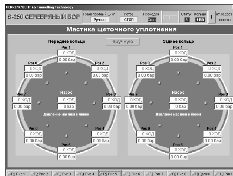
4 экран визуализации ТГМК 14,2 м: нагнетание мастики щеточного уплотнения
