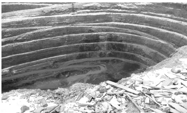
Рис. 3. Участок юго-западного борта карьера, гор.-125 м...-245 м (место выхода прибортового целика)
