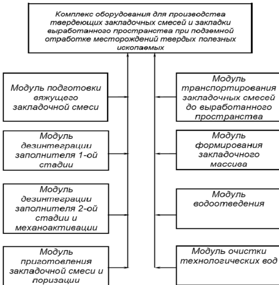
Рис. 2. Структурная схема закладочного комплекса модульного типа
