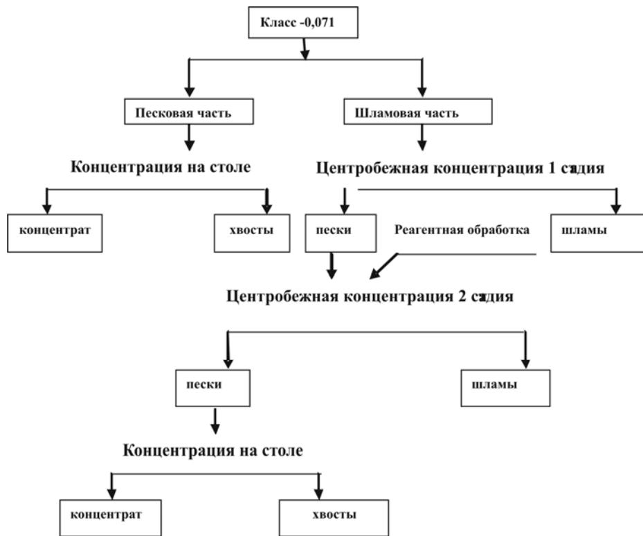
**Рис. 5. Схема обогащения золотосодержащего материала с использованием гидроциклона с предварительной обработкой материала реагентом**
