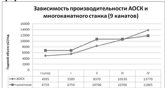
На основе моделирования установлены зависимости производительности однодискового станка с отрезным сегментом диаметром 3500 мм (АОСК) и многоканатного станка (при количестве канатов – 9 шт.) от параметров блоков и толщины распила (график). Размеры блоков для распиловки – 2000 мм х 1000мм х 1000 мм.
