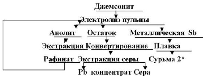
**Рис. 1. Принципиальная технологическая схема электролиза пульпы для обработки сурьмяно-свинцового концентратата**
