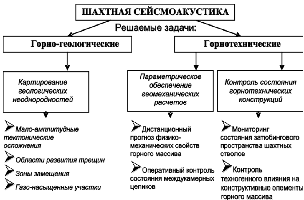
Рис. 1. Задачи, решаемые шахтной сейсмоакустикой на ВКМКС
