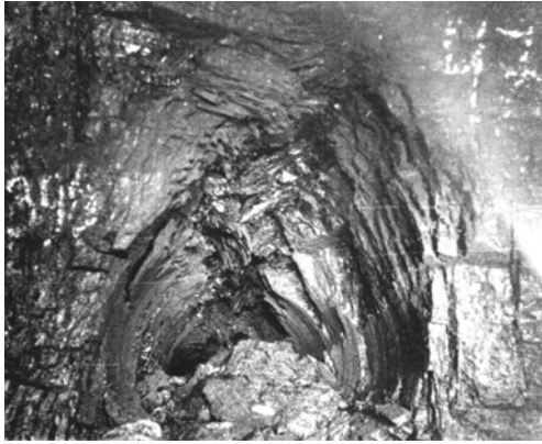
Рис. 3. Характер разрушения угольного массива вокруг скважины в пласте
