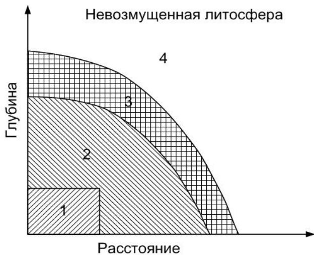
Рис. 6 Структура литосферного объекта, испытывающего техногенное воздействие: 1 — зона полного разрушения; 2 — зона изменения геофизических свойств; 3 — геофизический экотон (зона встречного вырождения свойств контактирующих систем); 4 — невозмущенная литосфера
