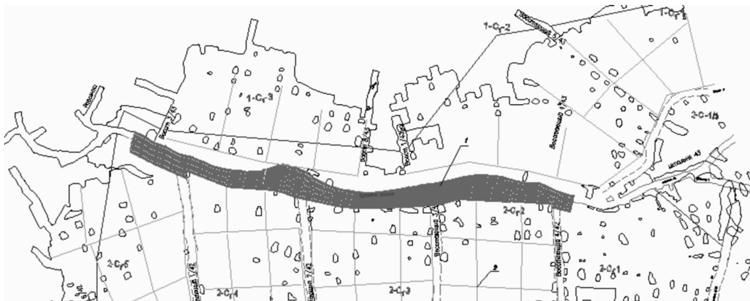
Рис. 6. Схема расположения бутовой полосы (1) в отработанном очистном пространстве (2). Жила Центрально-Тульская. Блоки 1-С1, 2-С1
