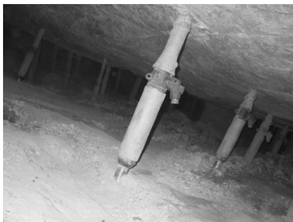
Рис. 4. Рабочая зона с заградительным экраном (а, б), зона зачистки (в), схема крепления зон расслабления взрывозащищенными стойками и анкерами (г)
