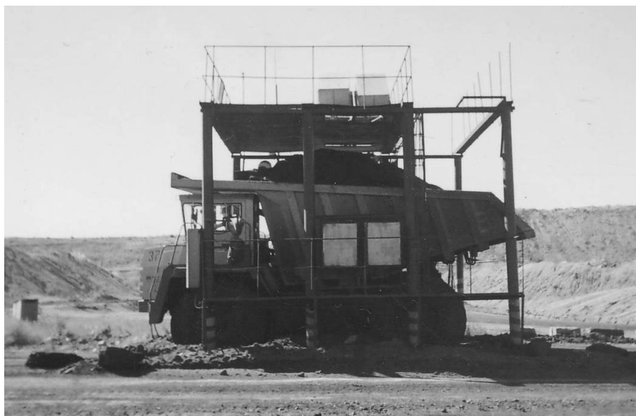
Контроль радиационно-гигиенических параметров угля в автосамосвалах БелАЗ на Уртуйском бурогольном разрезе
