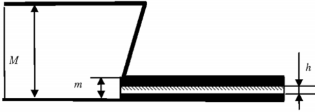
Рис. 3. Пласт с прослойкой: t – мощность пласта; M – высота обрушения; h – толщина прослойки
