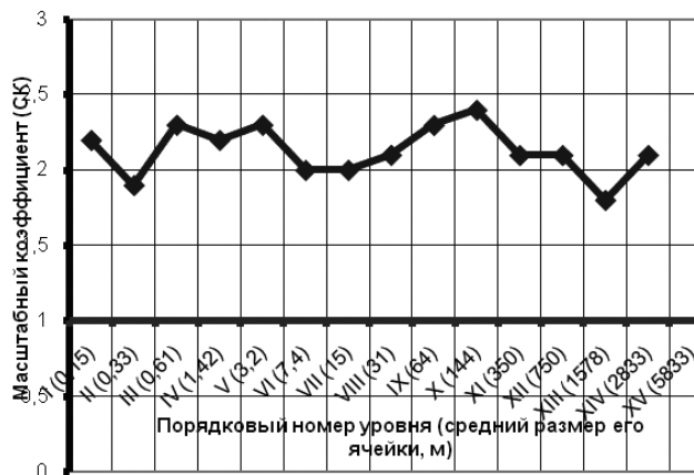
Рис. 3. Поведение масштабного (скейлингового) коэффициента (СК) в иерархическом ряду уровней структурной организации поля деструктивных элементов Зун-Холбинского месторождения
