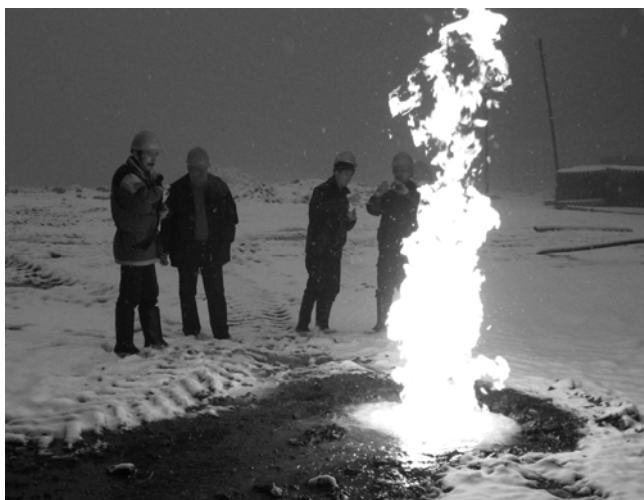
Рис. 1. Газовый факел на горизонте -230 м карьера Удачный (2007 г.)
