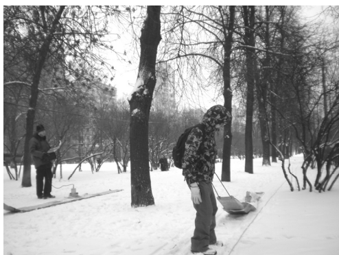
Рис. 3. Момент полевых работ с георадаром «Лоза-1Н»
