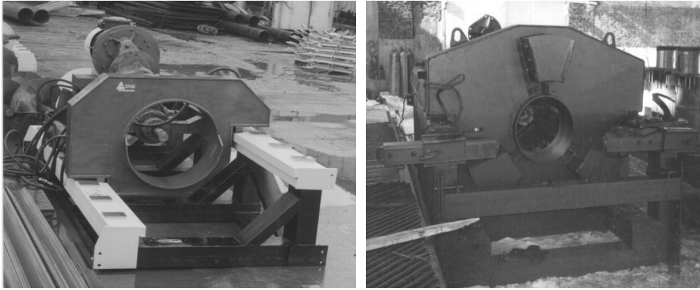
Рис. 1. а — бурошнековая машина с электрическим приводом; б — бурошнековая машина с гидравлическим приводом
