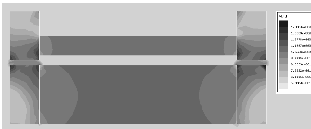
Рис. 3. Магнитная карта пространства магнитной системы шарикового сепаратора с замещением цепочки шаров однородной средой с той же эффективной кривой намагничивания (результаты трехмерного численного моделирования магнитного поля)
