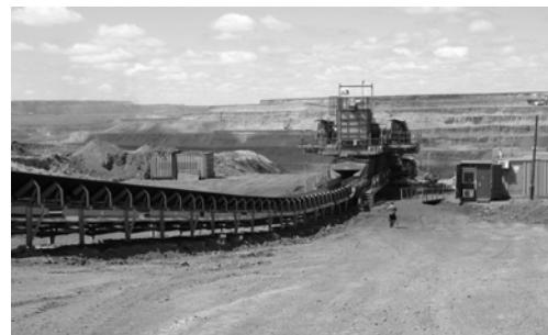
**Рис. 4. Конвейерный подъемник на вскрышных работах разреза «Восточный»**
