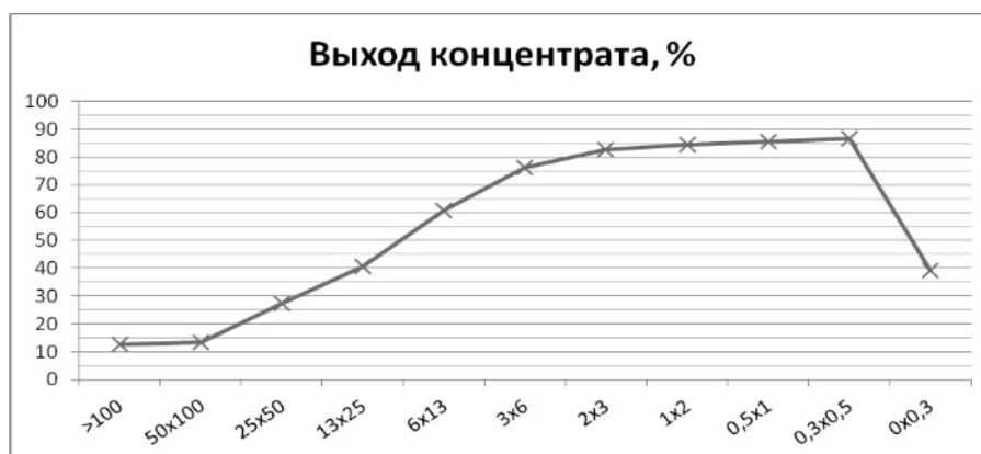
Рис.6. Зависимость относительного выхода концентрата зольностью 18% для элементарных классов исходного угля
