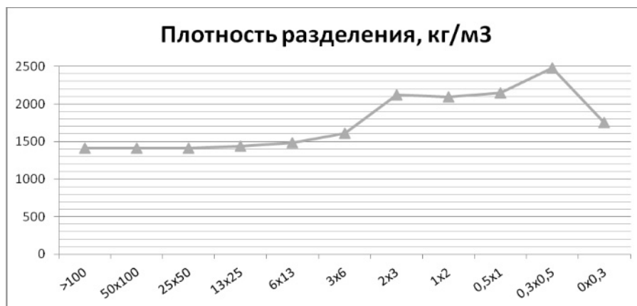
Рис.5. Зависимость плотности разделения продуктов для элементарных классов исходного угля при зольности концентрата 18%
