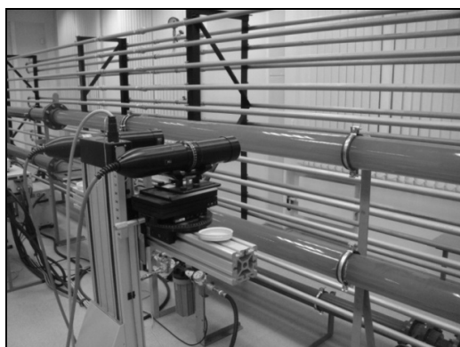
Рис. 1. а — схема экспериментальной установки «Поток» для исследования двухфазных сред в трубах с использованием 3D LDV System TSI Inc.; б) Схема экспериментальной установки для исследования гидродинамики вязких гомогенных и гетерогенных сред. Обозначения: 1, 2 — резервуары для масла и воды, соответственно; 3 — насос-дозатор; 4 — центробежный насос; 5, 6 — регуляторы расхода; 7 — двухфазный смеситель; 8 — сепарационная емкость; ПВ — проходной вентиль; P — область измерения давления; T — область измерения температуры; ОП — область «развития течений»; РП — область «развитого двухфазного потока»; ОВ — оборудование визуализации
