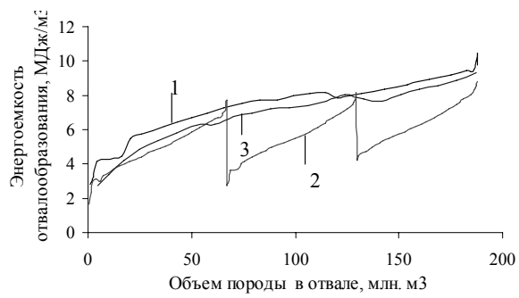
Рис. 1. Динамика энергетического параметра размещения породы в отвале с основанием круглой (а), вытянутой (б) и трапециевидной (в) формы по способу: 1 – отвал-ярус, 2 – отвал многоярусный, совмещенная отсыпка ярусов; 3 – отвал многоярусный, поярусная отсыпка
