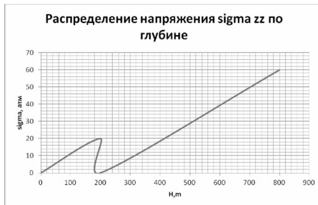
Рис. 2 Распределение давления в жидкости и главного нормального напряжения в породах дна по глубине
