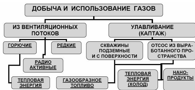
Рис. 2. Комплексное использование шахтных газов
