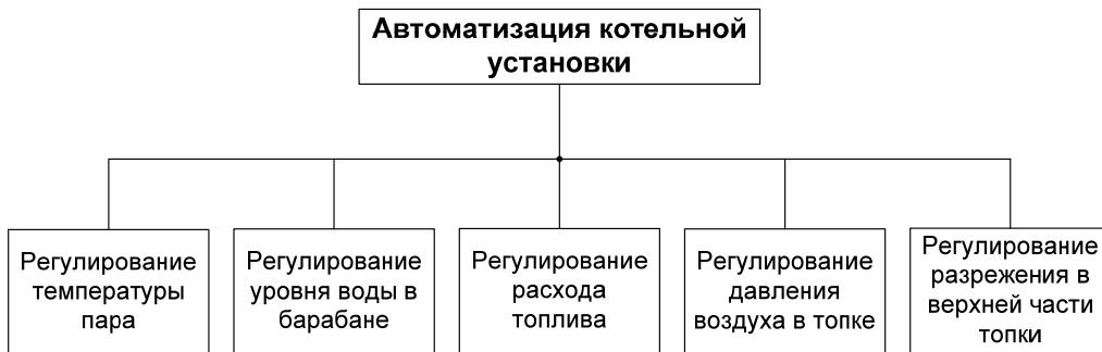
**Рис. 1. Задачи комплексной автоматизации котла**
