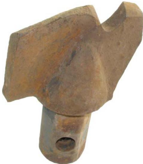
**Рис. 4. Долото ДРШ-151, упрочченное нитроцементацией, после наработки 2200 м**
