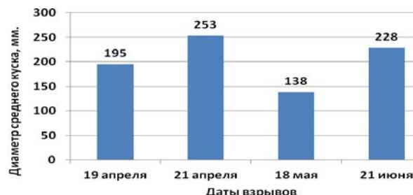
**Рис. 2. Размер среднего куска пород вскрыши в различные даты проведения взрывных работ**
