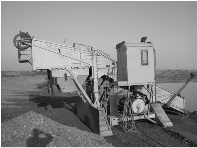
**Рис. 1. Скрепер канатный шагающий при глубинной добыче песчано-гравийной смеси**
