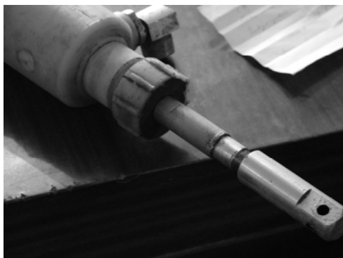
Рис. 1. Трубчатый аэратор, располагаемый по оси камеры пневмозарядчика ЗП-2
