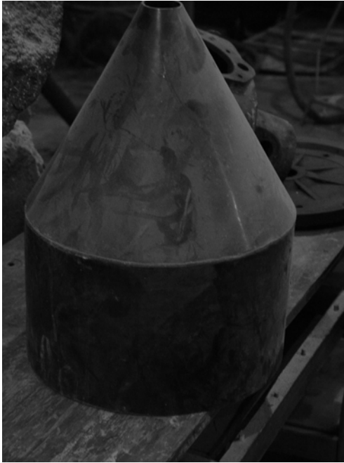
Рис. 3. Заготовка аэратора в виде цилиндрикоконического ложного днища пневмозарядчика «Кавказ»
