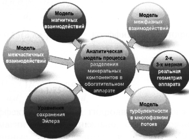
Рис. 1. Компоненты аналитической CFD-модели гидродинамических процессов разделения минеральных компонентов
