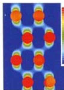
Рис. 2. Распределение напряженности магнитного поля в полиградиентной матрице
