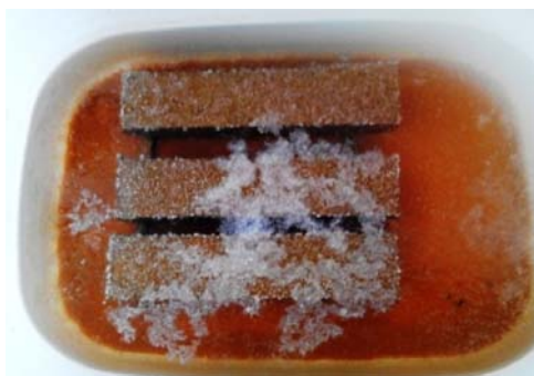
Рис. 1. Образование кристаллов соли на поверхности образцов, погруженных в рассол
