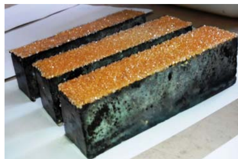
Рис. 2. Кристаллы соли и белёсый налёт на образцах бетона
