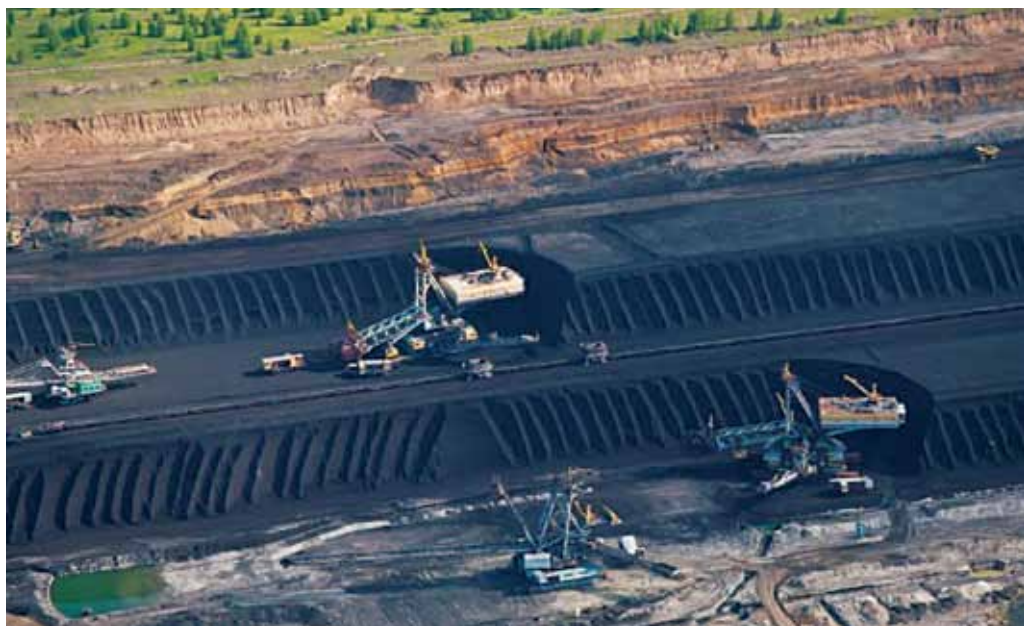
Рис. 2. Роторный экскаватор ЭРШРД-5250 № 139/2
