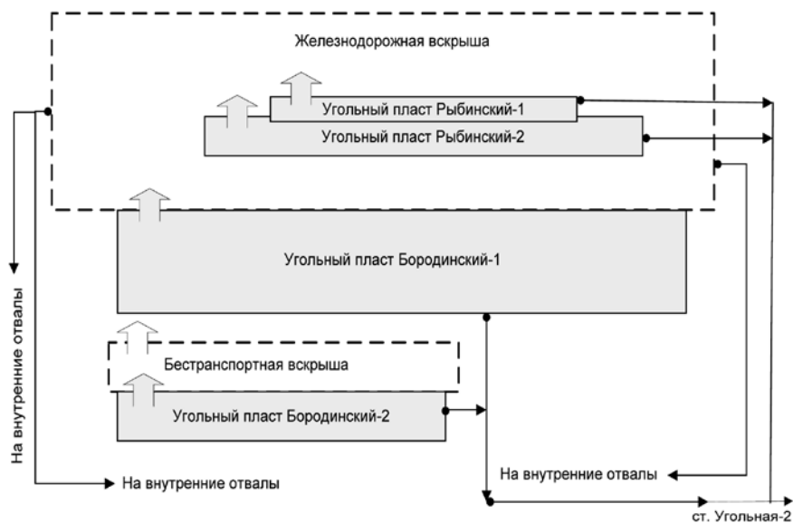
Рис. 3. Схема грузопотоков по предлагаемому варианту
