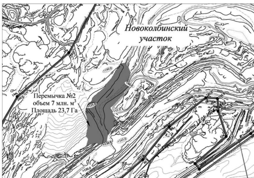
Рис. 7. Положение насыпной транспортной перемычки № 2
