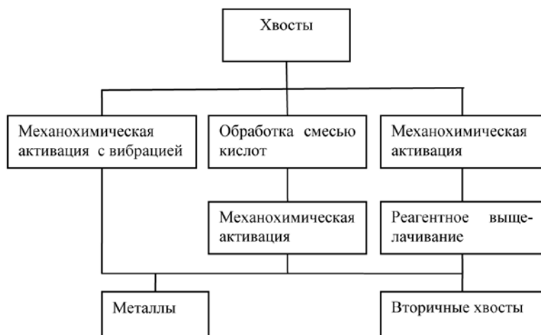
Рис. 5. Схема извлечения металлов из хвостов обогащения выщелачиванием в дезинтеграторе
