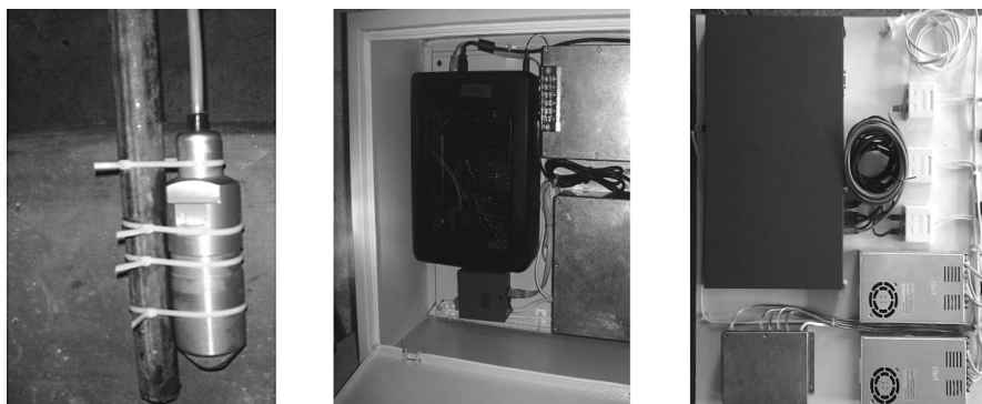
Рис. 2. Подземные модули микросейсмический измерительный комплекс «Prognoz S»
