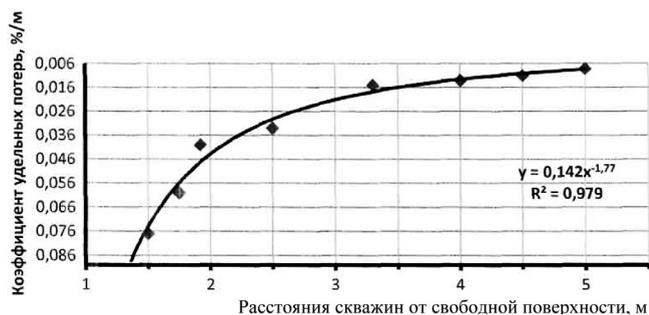
**Рис. 2. Зависимость расстояния скважин от свободной поверхности на коэффициент удельных потерь**
