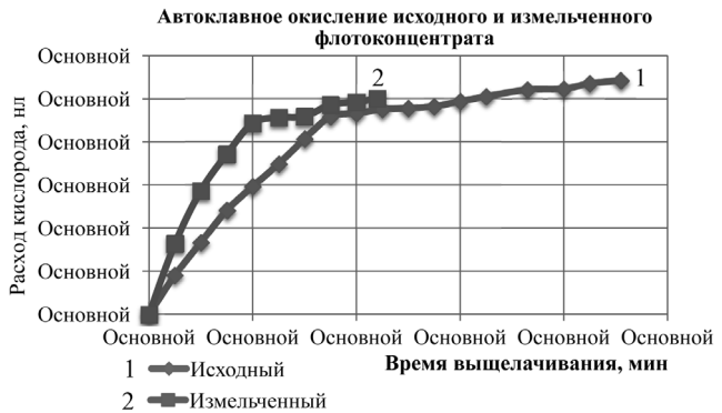
Рис. 2. Результаты автоклавного окисления пробы исходного и измельченного флотоконцентрата
