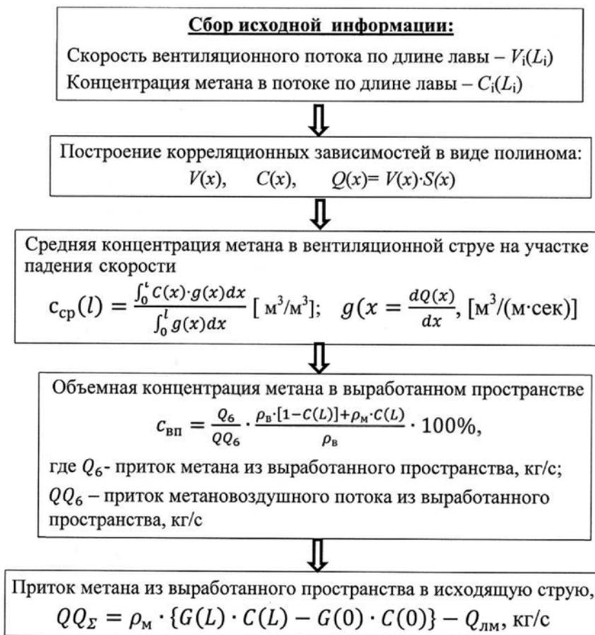
**Рис. 2. Блок-схема расчета концентрации метана в выработанном пространстве очистного забоя**
