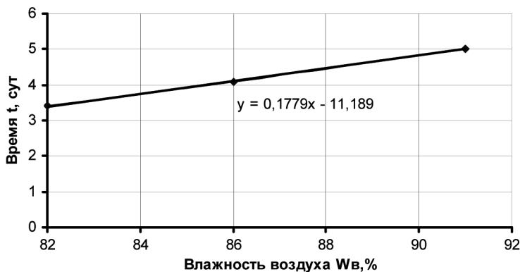
Рис. 7. Время полного высыхания глины в зависимости от влажности воздуха
