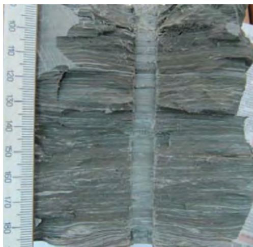
Рис. 10. Поверхность разрушения кембрийской глины
