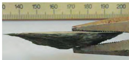
Рис. 2. Крупный элементарный скол при резании глины ( h = 10 мм, \alpha = 60^\circ )
